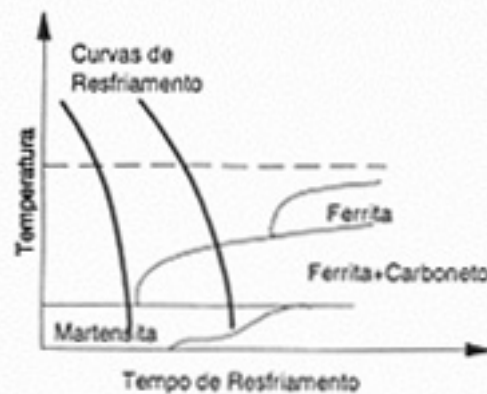
Figura 4 - Diagrama TRC para soldagem. (esquemático)
